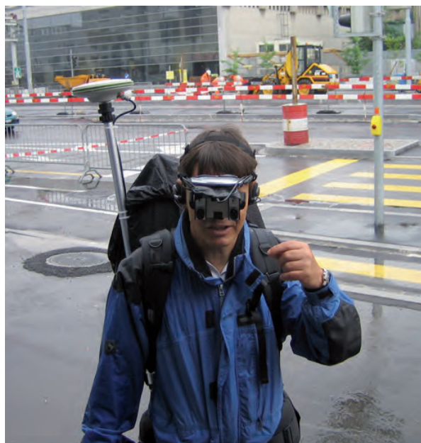
Abb. 1 Die tragbare lifeClipper2-Ausrüstung mit Computer, GPS sowie Brille mit Kameras und Kopfhörer im Einsatz auf der Voltastrasse. – Foto: Norbert Spichtig.
